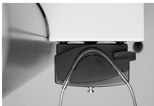
Rysunek 34 – Mocowanie wężyka pompy perystaltycznej
